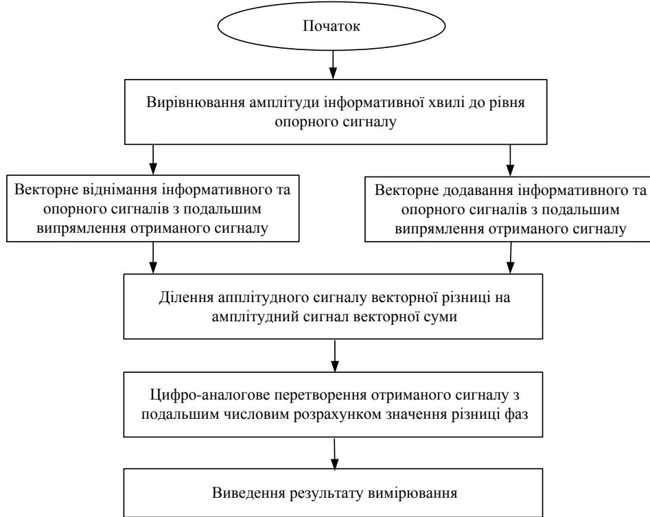
Рис. 2. Блок-схема реалізації запропонованого методу вимірювання різниці фаз
